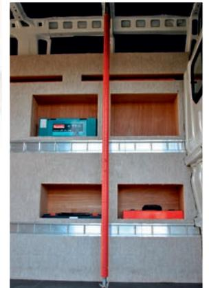
Verschiedenste Ladungssicherungssysteme möglich (Zurr- sowie Spannstangensysteme)
