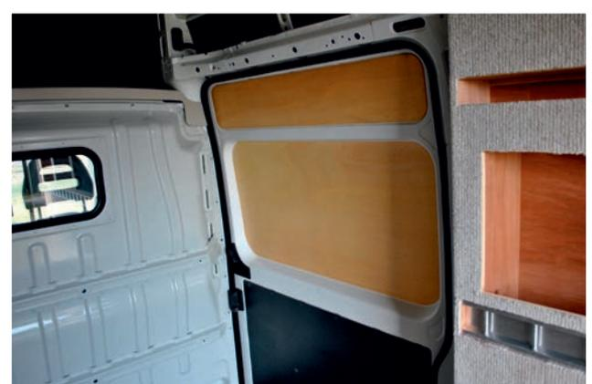
Sichere Montage von Regalsystem, Türverkleidung und Dämmung (hier schwarz) durch Verklebungen, somit entfallen Verschraubungen am KFZ dies verhindert zusätzliche Schwachstellen durch Korrosion
